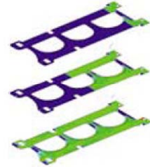
板型格栅支架卷下来时的最大拉伸应变，LEPS.(mm/mm)，未变形时的构型。
