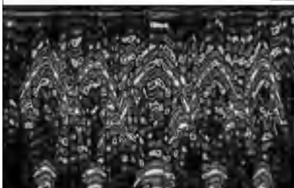
五孔小桥的探地雷达伪彩色图
