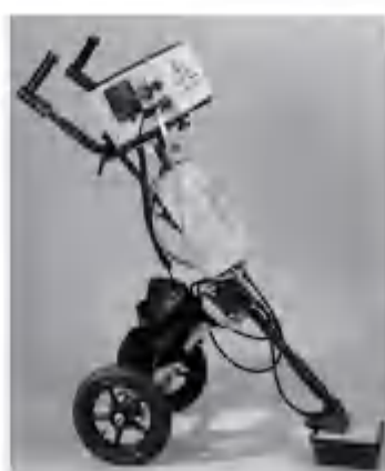
探地雷达仪器（雷达天线1GHz）
