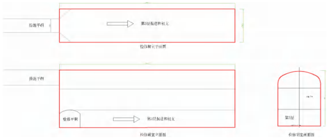
图 2-4 检修硐室，第三层施工
