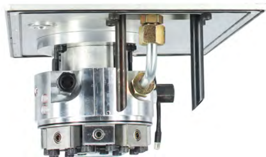
整体式泵头油路系统，紧凑无泄漏
