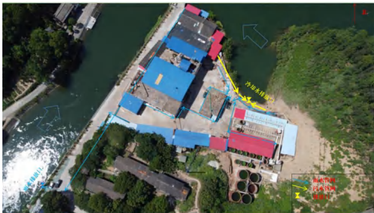
图 4-2 厂区雨水、污水流向示意图
