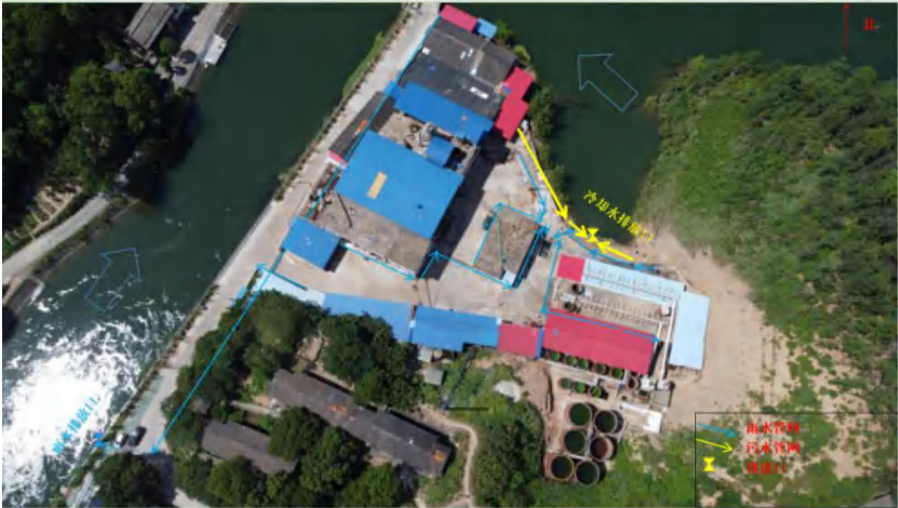
图 4-2 厂区雨水、污水流向示意图
