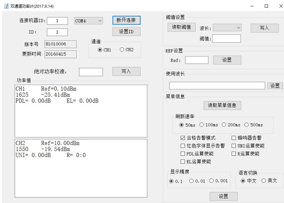
图 7-3-1 测试软件界面（完成连接）
