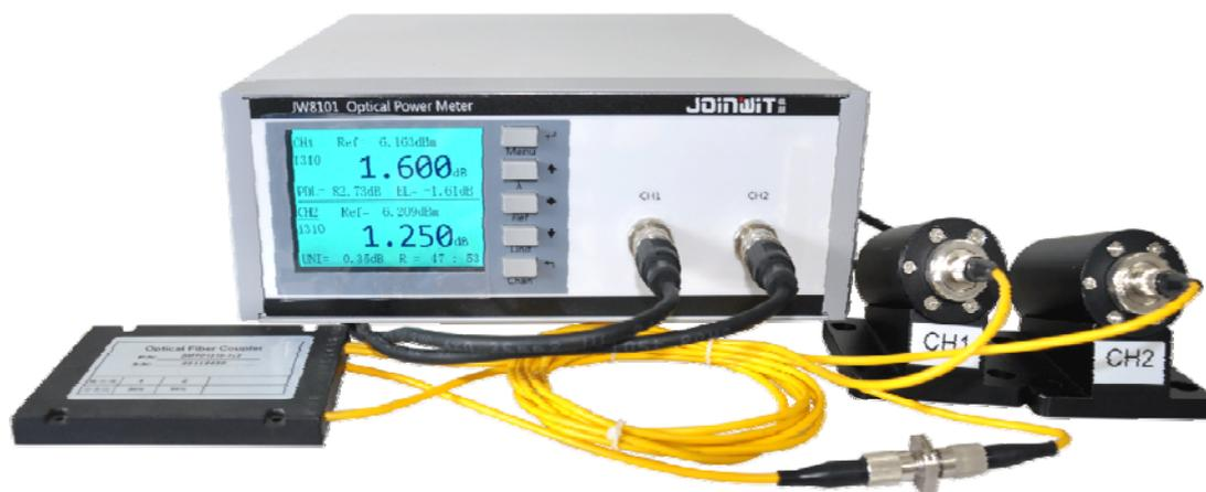
图 5-1 1X2 器件连接图
