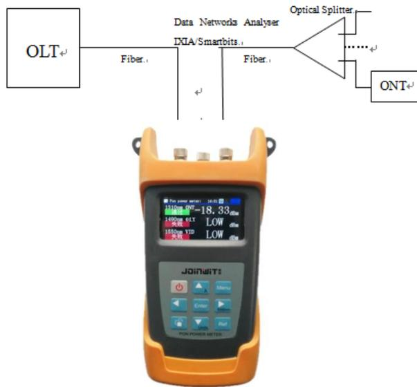
图 3-3 OLT PON 接口平均发送光功率测试配置图
