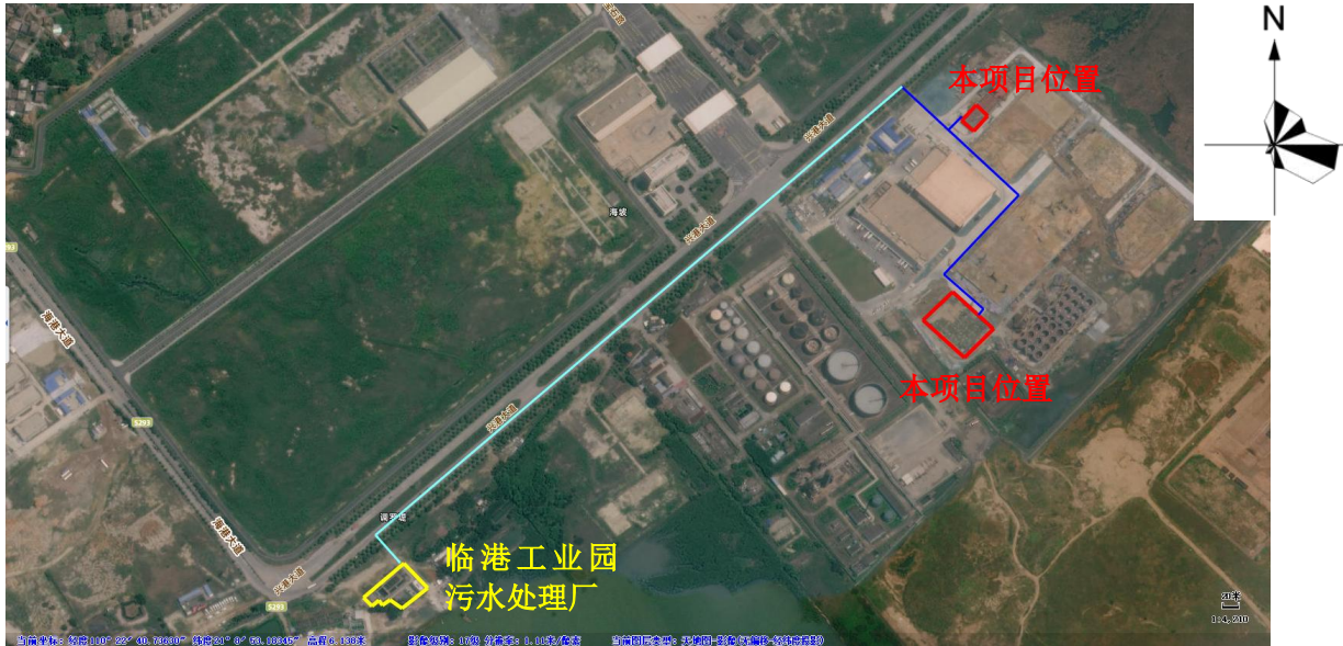
图 4-1 外部污水管网路线图
