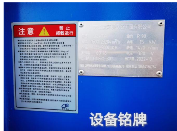
废气处理设备风机铭牌
