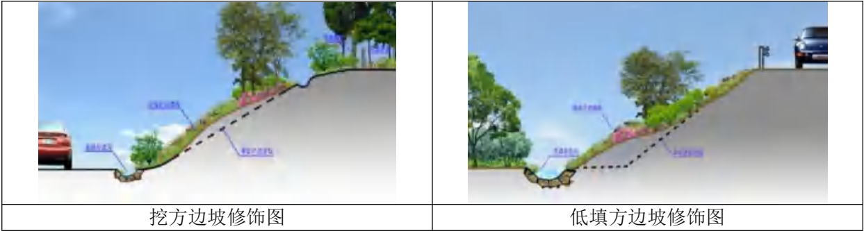
图3.2-7 路基边坡修饰图
