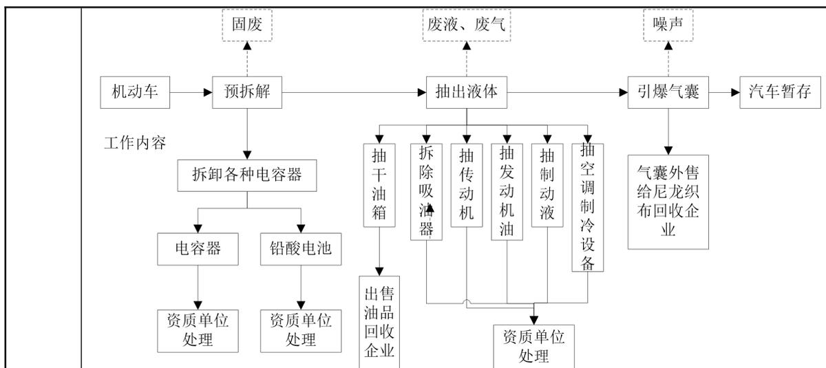
图 2-2 汽车拆解预处理工艺流程图
