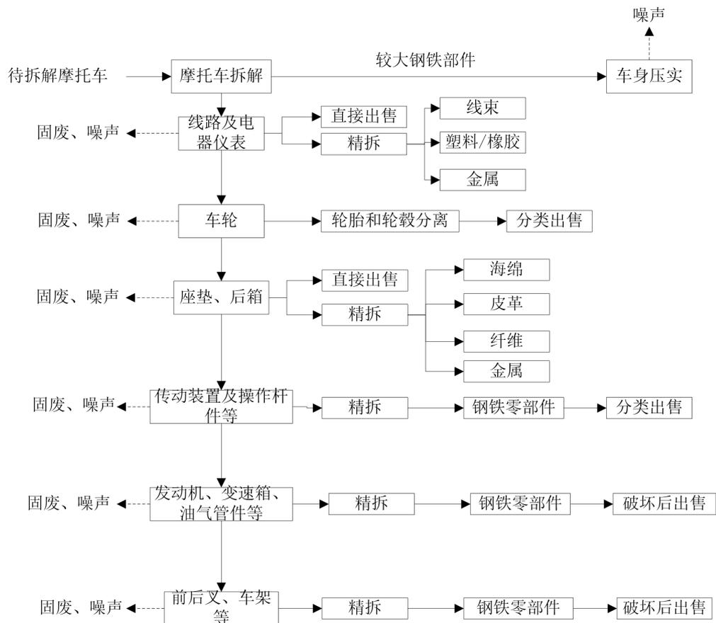
图 2-6 报废摩托车拆解流程示意图
