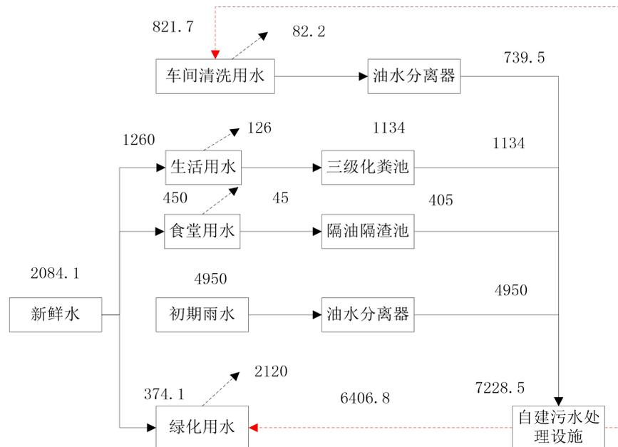
图 4-1 项目水平衡图 (单位: t/a)
