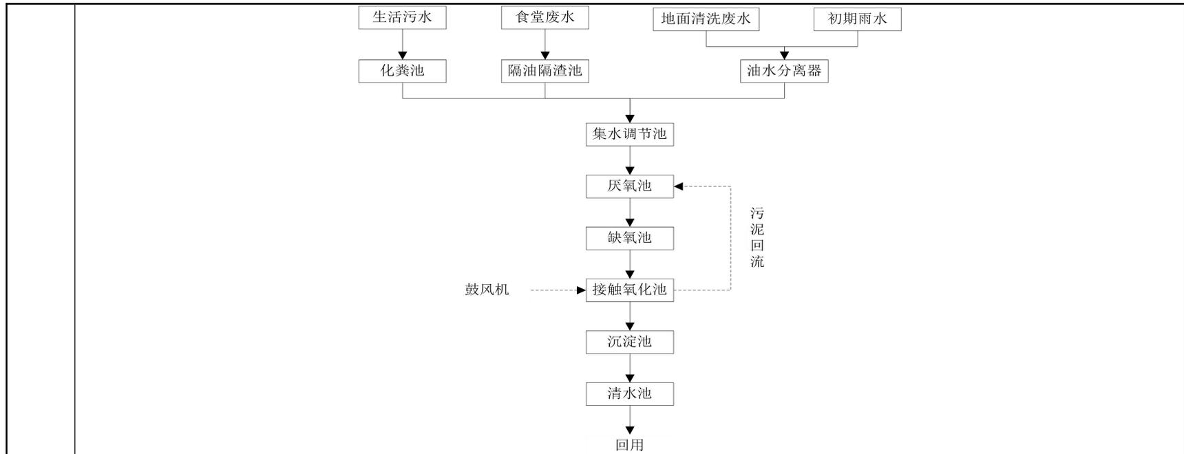
图 4-2 本项目自建污水处理设施工艺流程
