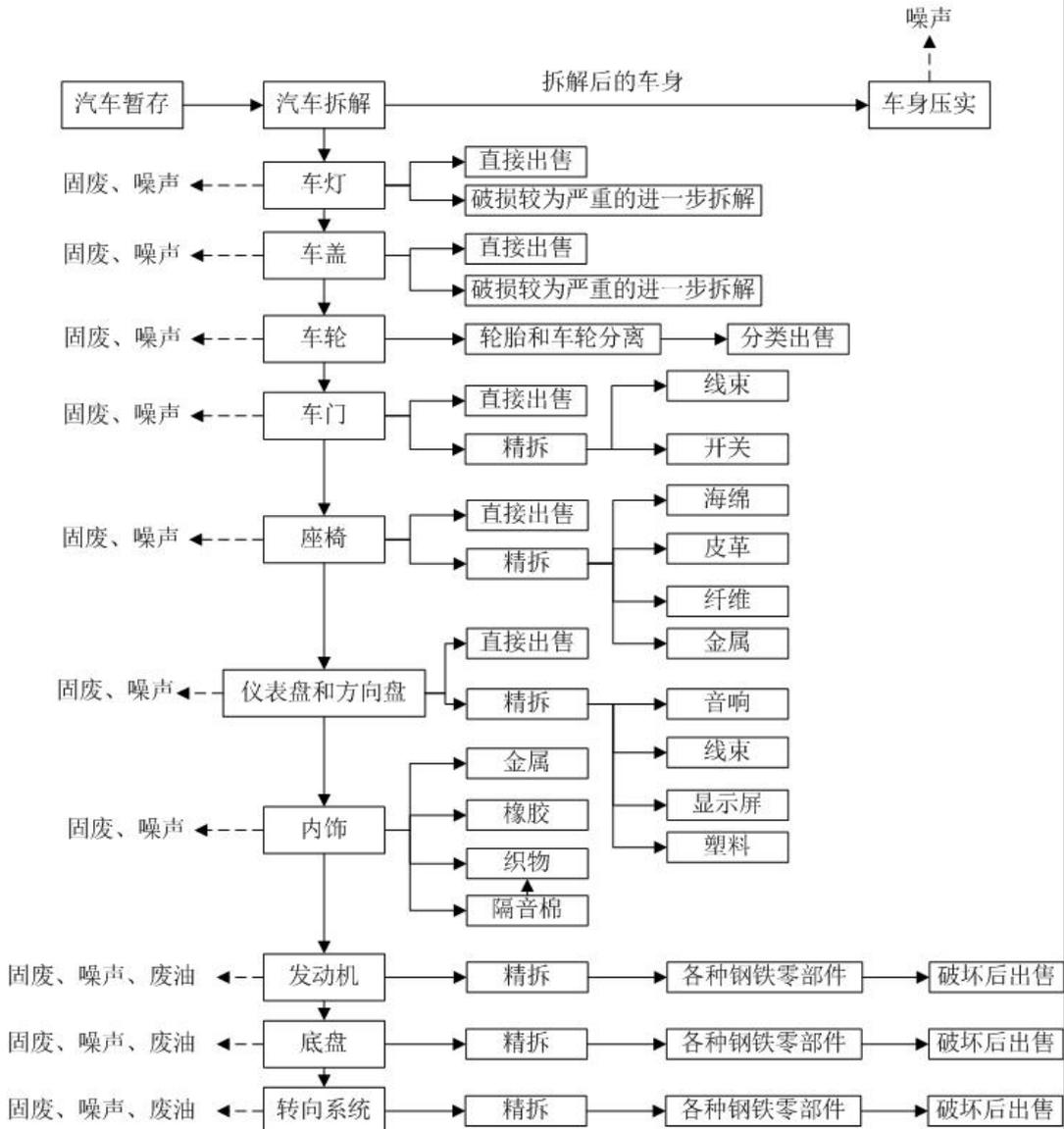
图 2-4 报废小汽车、电动汽车、中大型汽车拆解流程图
