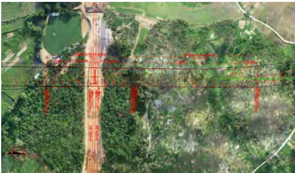
图 3.5-1 下穿广湛高铁 U 型槽平面布置
