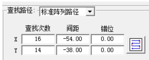
**查找次数：**输入材料上 XY 方向要拍照的次数，注意相机幅面范围内一次拍多少个单个图形，“拍多少个”作为拍照一次。
