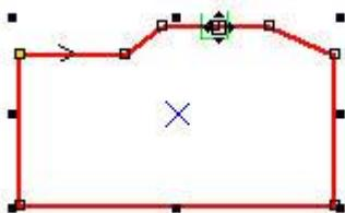
将鼠标放到节点上，拖动鼠标即可改变图形的形状。
