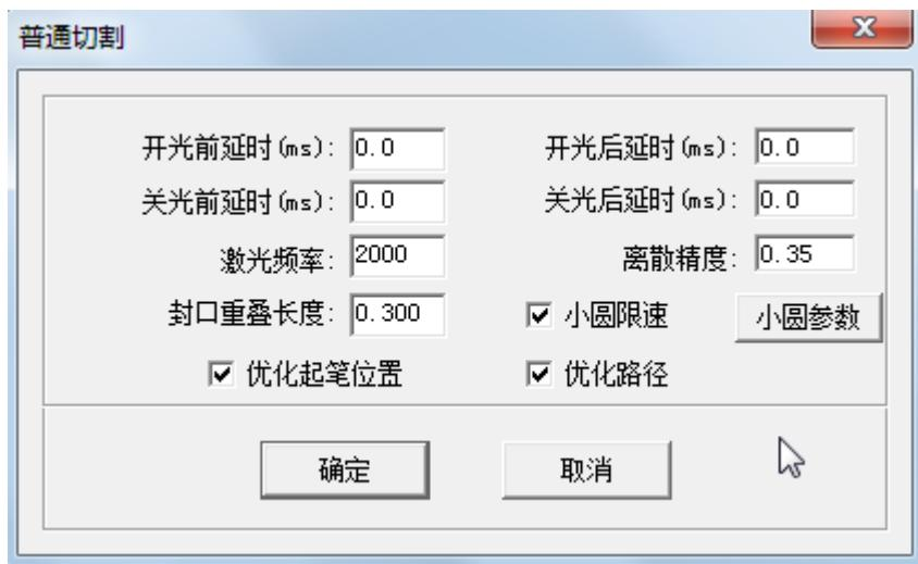
**小圆限速:** 用户可以选择是否启用限速功能。点击“**小圆参数**”可设置不同大小圆的速度，视用户实际情况调节参数。
