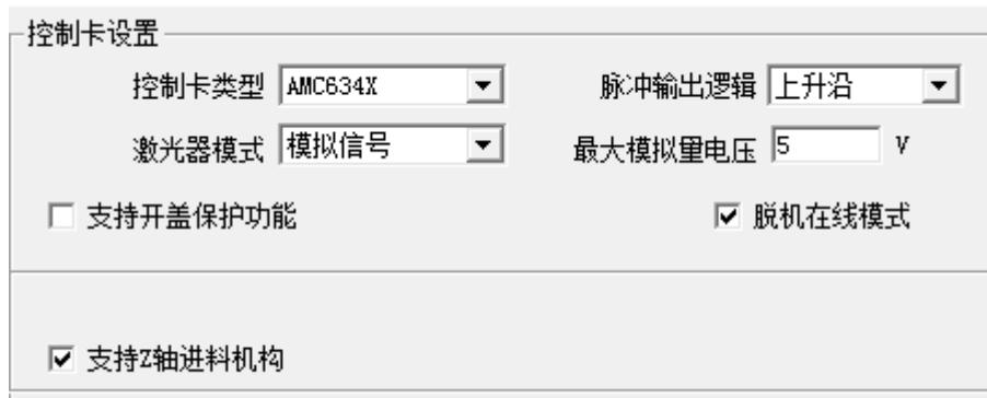
**控制卡类型：**依据厂家实际使用的控制卡类型选择相应的控制卡。一般情况下有 GES400 和 AWC634X；
