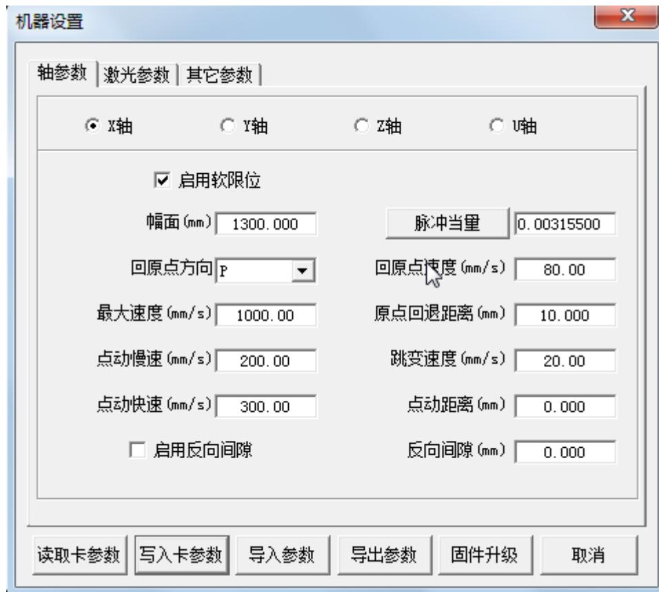
**轴参数:** 分别设置 XYZU 的轴参数。X 轴代表横向轴, Y 代表纵向轴, Z 代表送料轴, U 代表双头互移轴。
