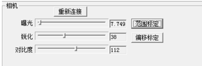
确保相机连接正常，镜头调节固定（computer8MM 镜头：上节圈调亮度，下节圈调焦距；CCTV6-12MM 镜头：上节圈调相机幅面，中间节圈调节亮度，下节圈调节焦距）后，点击“范围标定”，即出现如下对话框：
