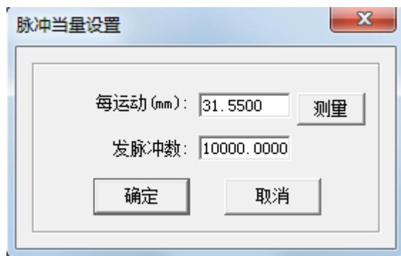
上图中的 31.5500 表示电机每转一圈激光头移动的距离为 31.55mm。10000.0000 表示步进电机每转一圈需要 10000 脉冲。
