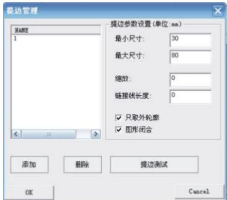
2. 设置【提边参数】设置，如上图所示，设置提取边缘的【最小尺寸】，【最大尺寸】单位（毫米）：
