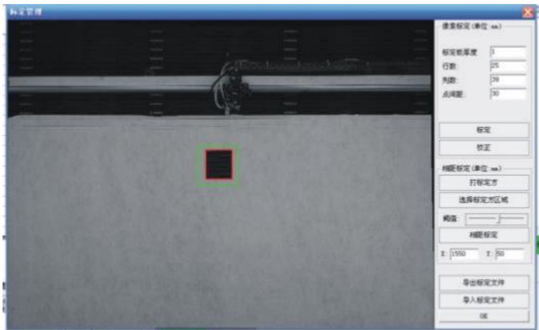
点击【相距标定】，提示相距标定成功，点击【标定管理】界面右下角的【OK】，标定完成。
