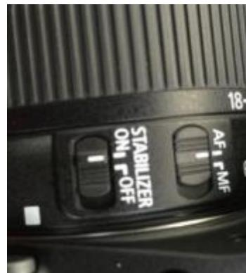
5. 标定完成后，镜头上的按钮打到【MF】和【OFF】，如图所示：
