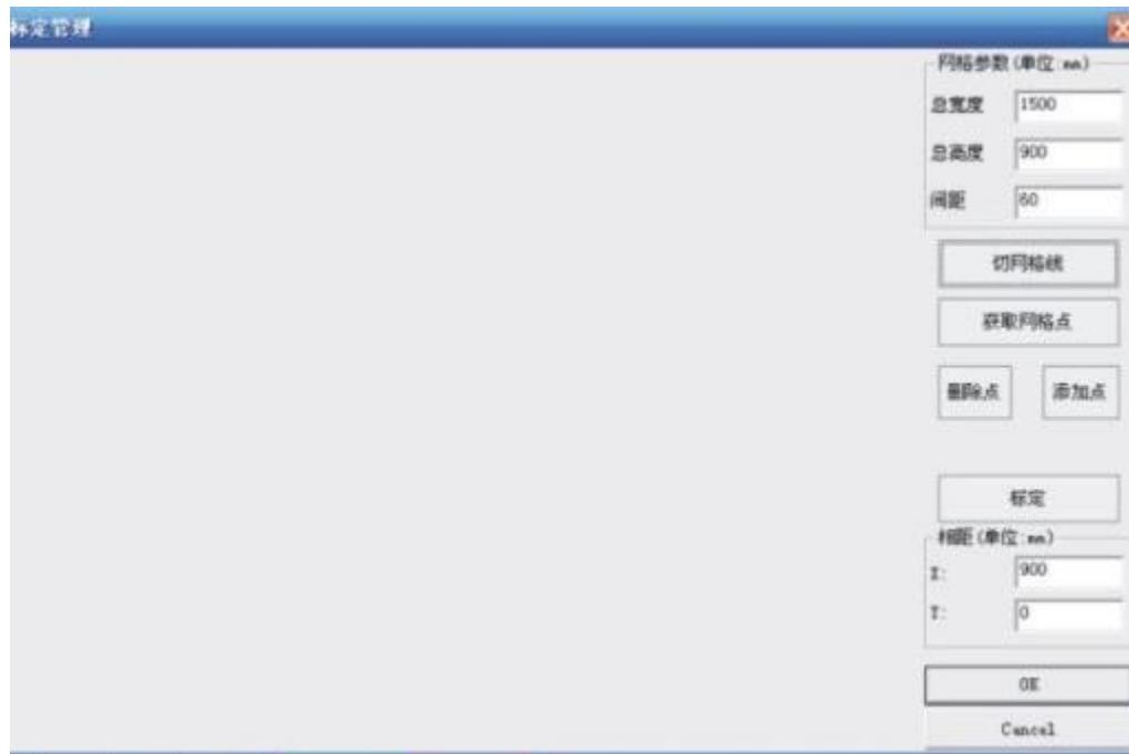
3. 设置所需要的幅面，例如（上图）设置所需的幅宽为 1.5 米，幅长 0.9 米，则在【总宽度】设置 1500，在【总长度】设置 900。
