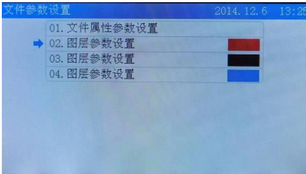
移动光标到需要修改的选项，按【Z↑】【Z↓】修改参数，点击【确定】键完成修改。
