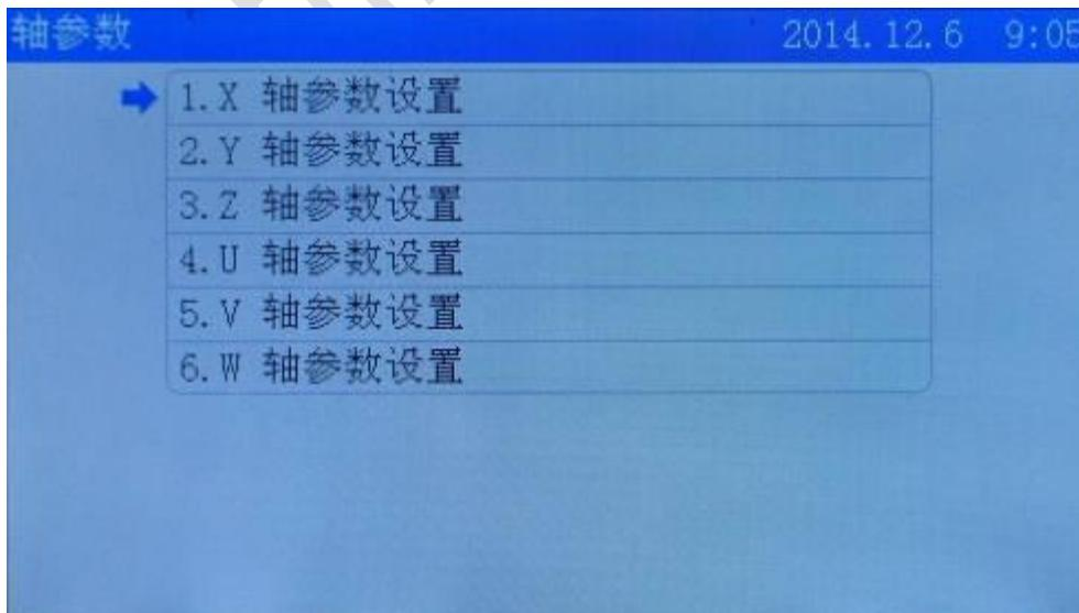
在轴参数设置界面移动光标到 X 轴参数设置选项，点击【确定】键进入 X 轴参数设置界面。移动光标到需要修改的选项，按【←】【→】修改，按【确定】键完成修改。
