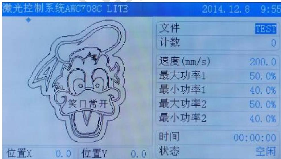
再次点击【确定】键进入文件参数设置界面，移动光标到【文件属性参数设置选项】，点击【确定】键进入设置文件属性界面
