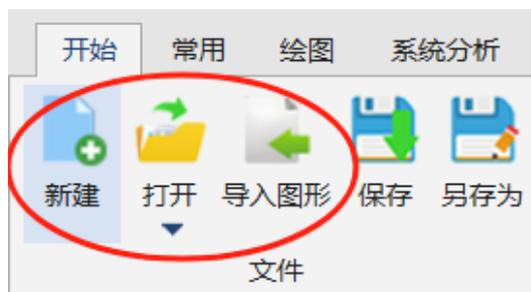
选择“新建”可新建视图区，用户可使用绘图工具现场绘制需要的零件。
