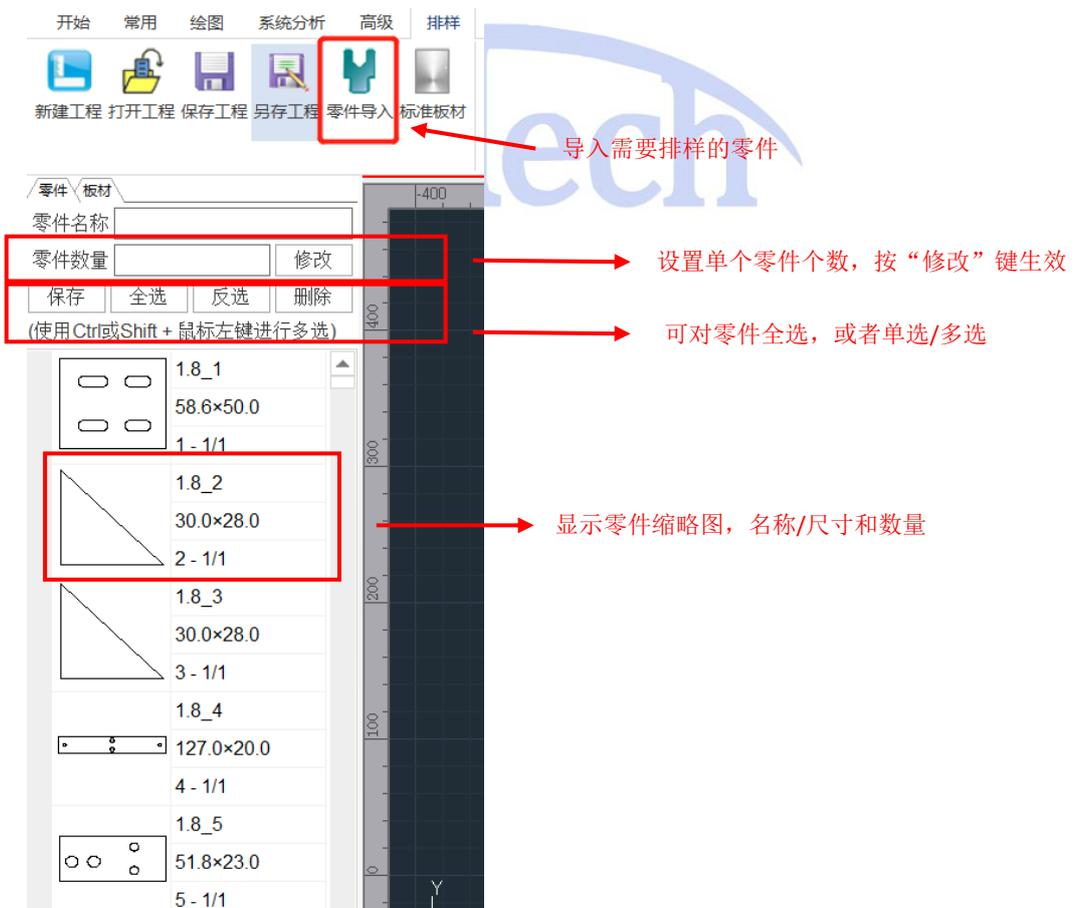
**小技巧：**除了可以导入零件外，还可以手动添加指定零件。方法是在视图区选择需要添加的零件，点击“添加零件”按钮，设置零件数量即可。
