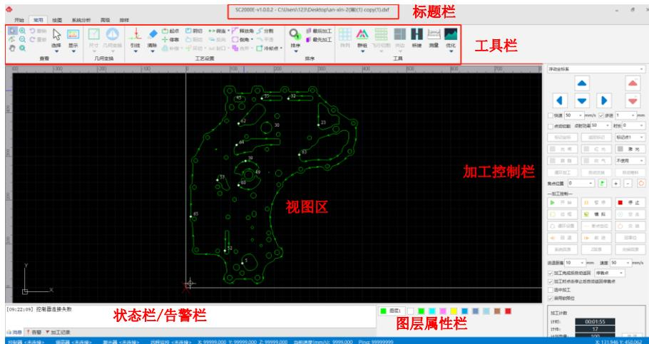
用户界面层次分明，从上往下分为标题栏、工具栏、告警栏、视图区、加工控制栏、消息栏、图层属性栏、状态栏。各区域主要作用参考下表：
