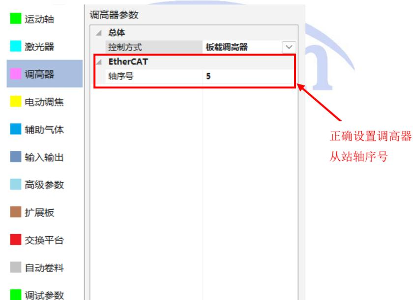
**电动调焦：** 配置电动调焦头控制方式可支持脉冲轴和总线轴。当用户选择总线轴控制时需正确配置从站轴序号。
