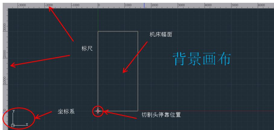
**坐标系：**程序加工时默认采用浮动坐标系，切割头停靠位置（即视图区~~X~~位置）为图形加工零点。用户加工前可运行模拟/走边框功能，确认被加工图形在行程内。
