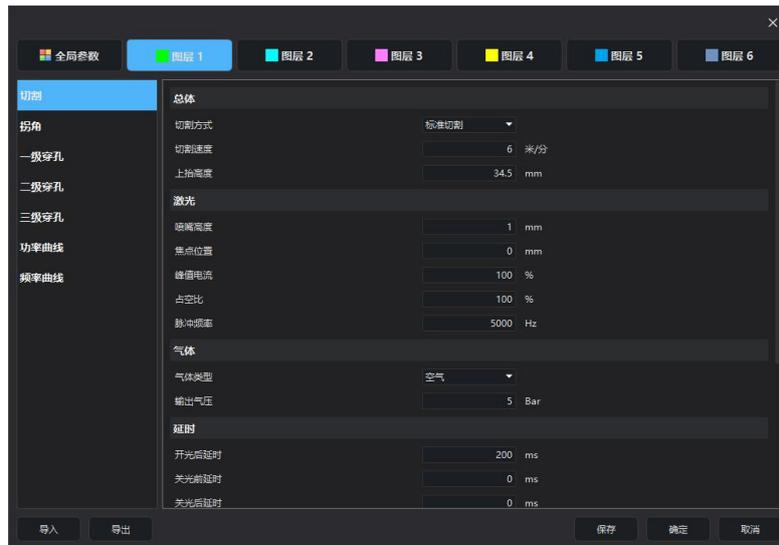
用户可以设置切割方式、切割速度、激光功率、气体类型及大小、跟随高度等多个关联参数，另外支持三级穿孔、拐角工艺、功率/频率曲线设置，从而达到最佳切割效果。
