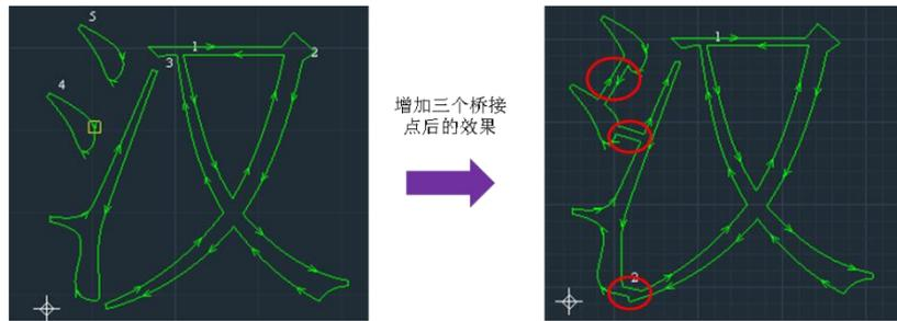
5、**共边**：将不同图形可重合的直线部分进行拼接，减少材料浪费，降低加工时间。
