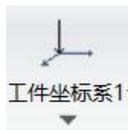
**工件坐标系1**：使用前需要手动设置工件原点（通过移动机床位置并手动设置，在软件上有标识）。加工时，不管切割头当前停靠在何处，均以设置的工件原点为加工原点进行加工。此坐标系多用于同一种板材同一种图形多次加工场合，配合工装夹具可以快速加工。目前软件可同时记忆六种工件坐标系。
