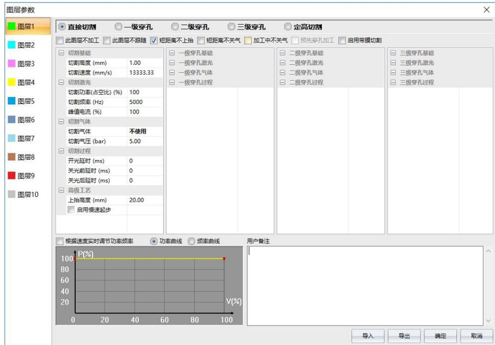
用户可以设置切割方式、切割时速度、激光功率、气体类型及大小、跟随高度等多个关联参数，从而达到最佳切割效果。
