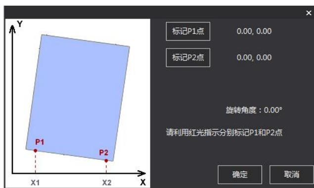
用户可以开启激光器红光，找到 X 方向板材边缘点 P1，点击“标记 P1 点”，移动机床至 X 方向板材边缘点 P2，点击“标记 P2 点”。软件自动测算板材倾斜角度，并调整坐标系。点击“确认”键即可完成巡边功能。
