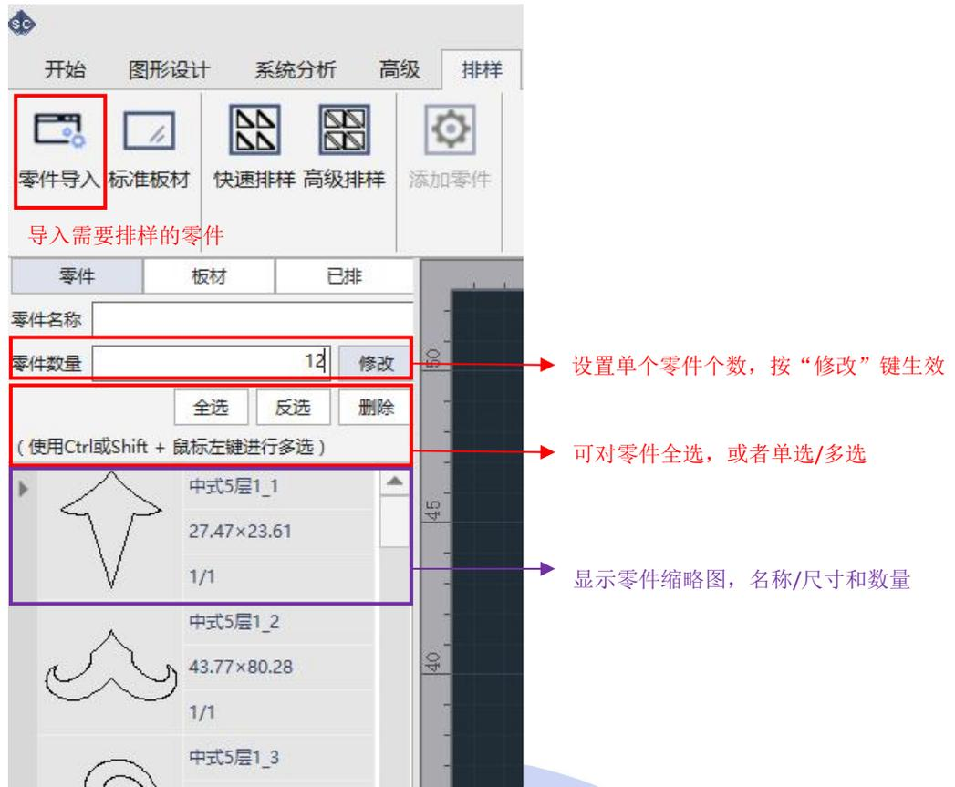
小技巧：除了可以导入零件外，还可以手动添加指定零件。方法是在视图区选择需要添加的零件，点击“添加零件”按钮，设置零件数量即可。
