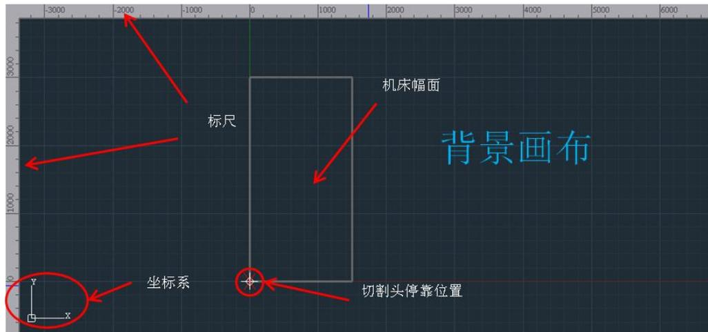
**坐标系：** 程序加工时默认采用浮动坐标系，切割头停靠位置（即视图区  $\times$  位置）为图形加工零点。用户加工前可运行模拟/走边框功能，确认被加工图形在行程内。
