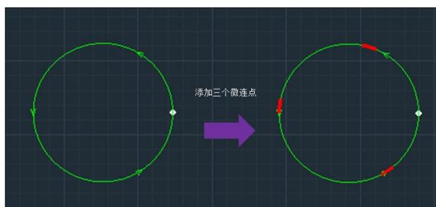
**自动微连：**用户可设置微连数量或微连间距，软件自动对图形设置微连点。若对微连设置不满意，还可以通过“清除微连”功能清除选中图形的所有微连点。
