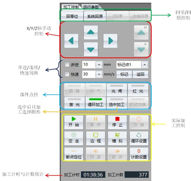
系统支持手动控制 X 轴、Y 轴、Z 轴移动，移动方式（步进/连续/快速）移动速度可设置。
