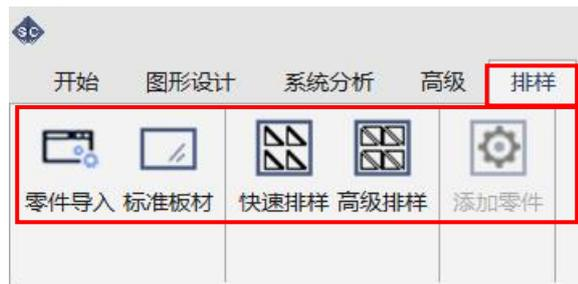
排样功能主要用于材料切割前，将各种不同大小、不同形状、不同数量的零件按一定的策略排入设定的板材内部，保证材料利用率最大化。
