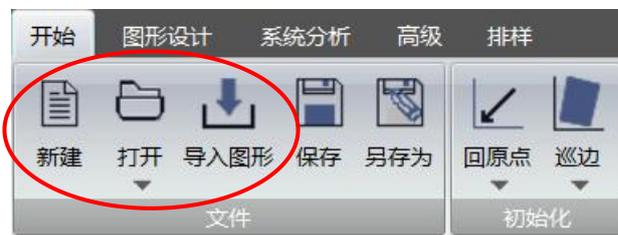
选择“新建”可新建视图区，用户可使用绘图工具现场绘制需要的零件。
