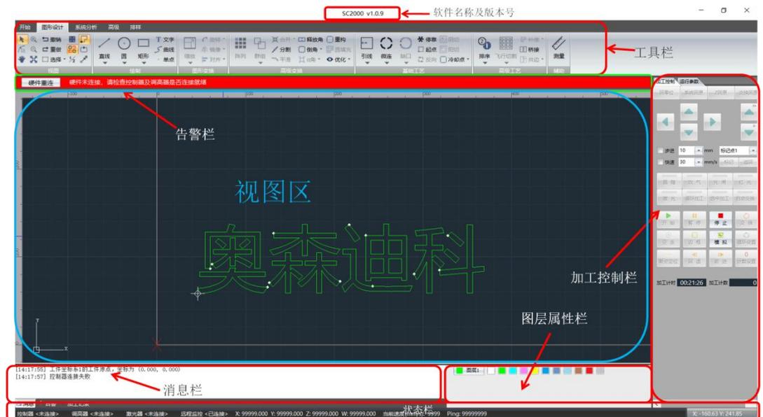
用户界面层次分明，从上往下分为标题栏、工具栏、告警栏、视图区、加工控制栏、消息栏、图层属性栏、状态栏。各区域主要作用参考下表：
