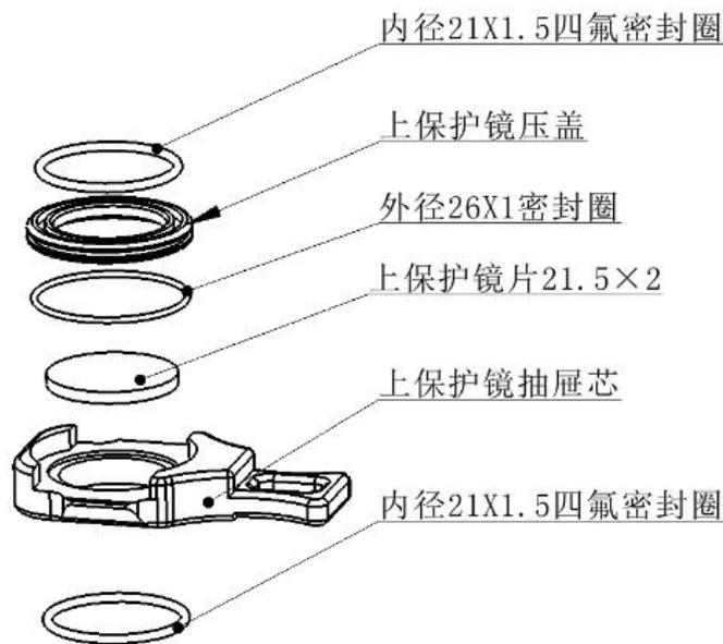
**图 5.4 — 准直保护镜结构**
