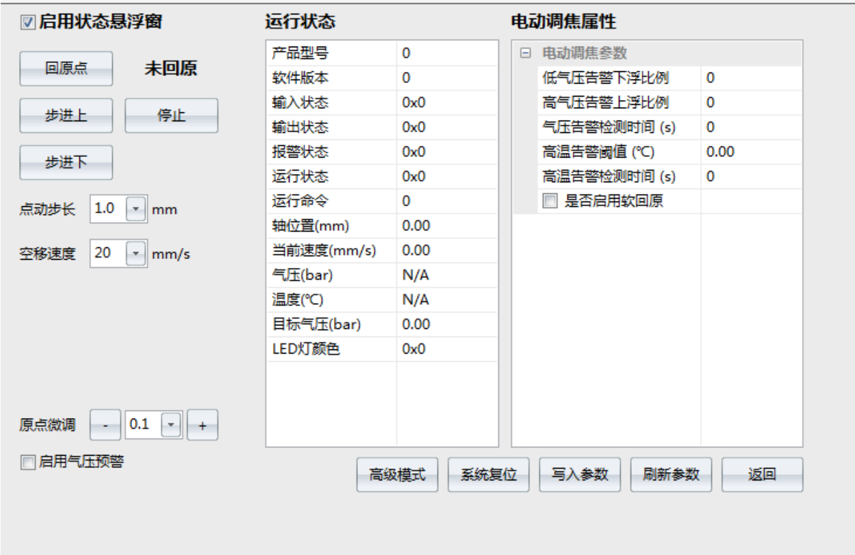
图 10 SC 系列数控软件对 A230E 进行调焦操作
