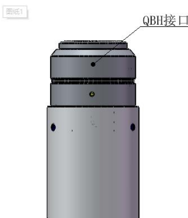
图 6 A135M 激光头光纤输入接口——QBH
