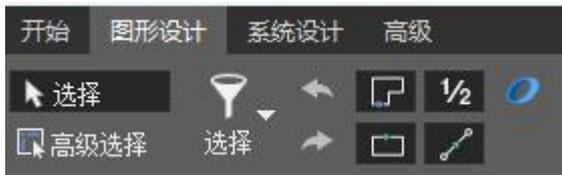
通过“选择”下拉菜单用户可以选择“所有轮廓”、“反选所有轮廓”、“选择非封闭轮廓”，快速找到同一性质的加工轮廓。当图形有使用打断工艺时，当需要单独选中打断部分的轮廓时，可使用高级选择进行选中需要的部分。
