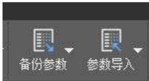
点击参数备份；可对软件参数进行保存本地，并自定义命名，保存的文件包含图层参数，硬件配置参数，运行参数。
