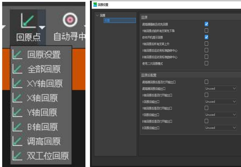
在开始目录栏内点击回原点下拉菜单，可进行回原设置，及选择不同类型回原组合。
