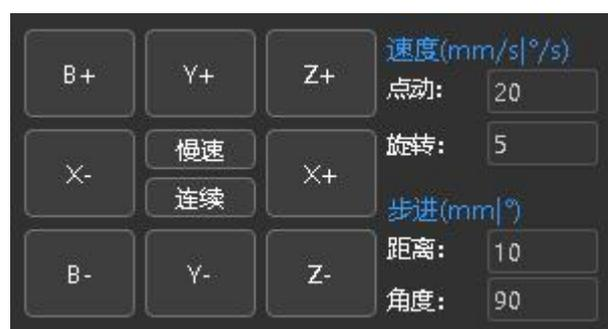
慢速点动各轴，如果有软限位报警，可以在工具栏中暂时关闭软限位保护；点动无误后，依次触发各轴的原点和限位开关（不要点动轴，假如限位开关是光电式开关，就用挡片遮挡光电开关），观察报警界面上是否有对应的报警信号。
