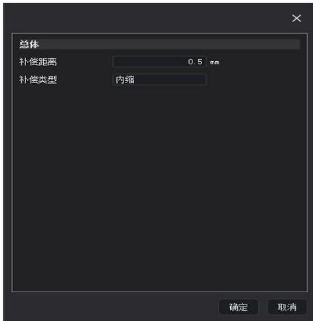
下拉菜单可选焊缝补偿功能；可针对图形添加焊缝补偿工艺，该工艺会根据图形壁厚补偿干涉距离。添加焊缝补偿后，加工刀路会沿黄色线条进行避让，即加工黄色线条部分。
