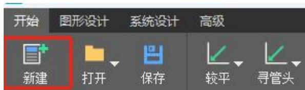
新建：选择“新建”可新建 3D 图形，用户可使用绘图工具现场绘制需要的零件，步骤如下：
