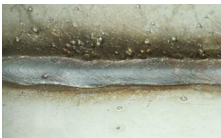
避免焊接飞溅和不平整焊缝。© Outokumpu
