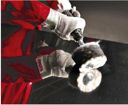
磨光工艺增加不锈钢表面光泽。©MagicDisc
