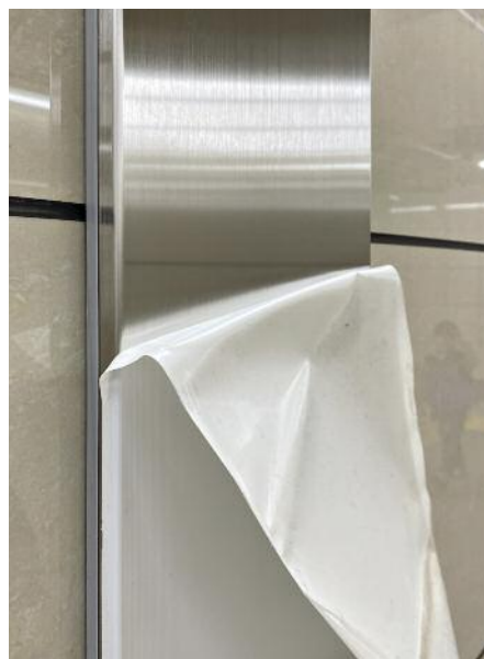
可剥离膜保护不锈钢表面，避免在制造和运输过程中划伤和沾污。© IMO A
