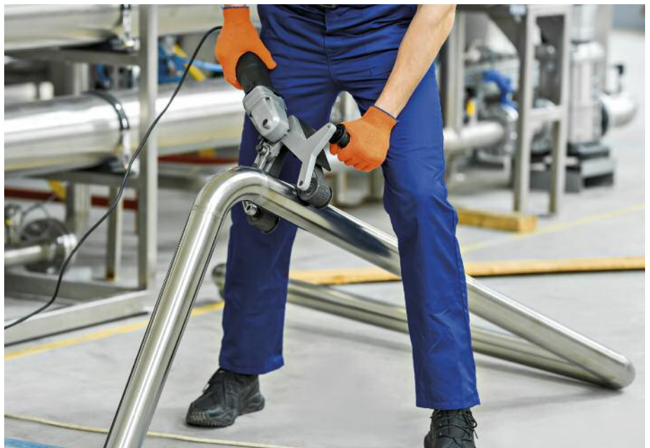
人工抛光不锈钢管，使焊缝与钢管饰面相融合。© Olya Humeniuk/Shutterstock.com
