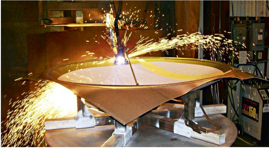
用于卫生用途的GTA焊接和液压成型的奥氏体不锈钢容器封头在进行等离子切割。 © DCI, Inc, St. Cloud, MN USA
