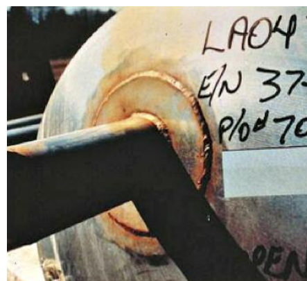
用碳钢丝刷清理不锈钢焊缝造成的变色和锈迹。© Outokumpu Stainless
