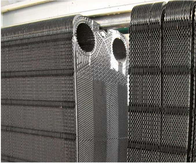
冷成型换热器板的复杂图案。© Graham Sussex
