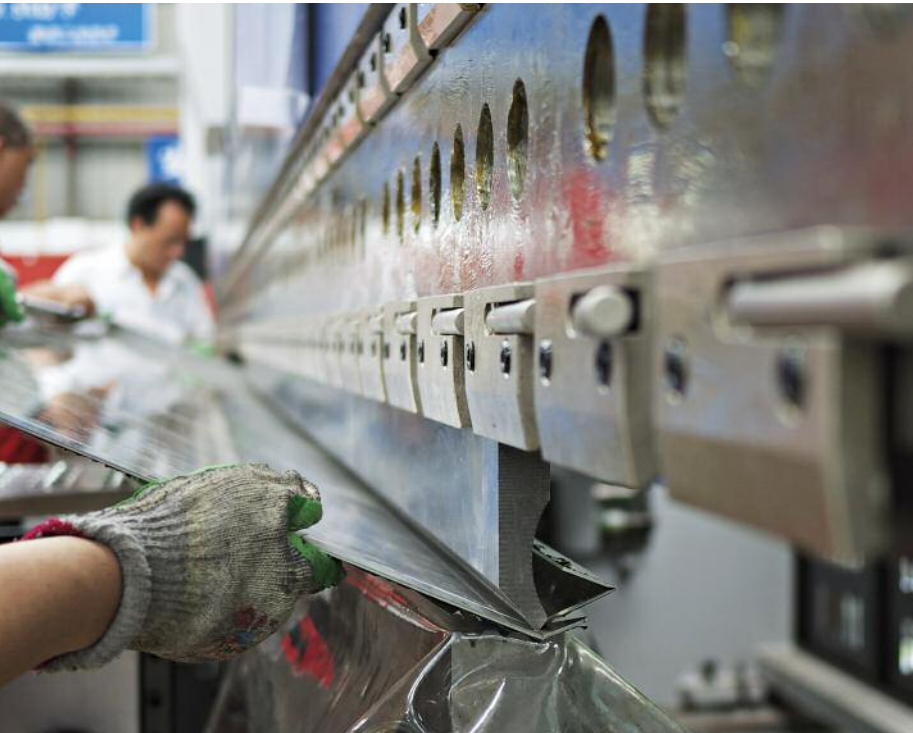
压弯机弯曲不锈钢板。© IMOA
