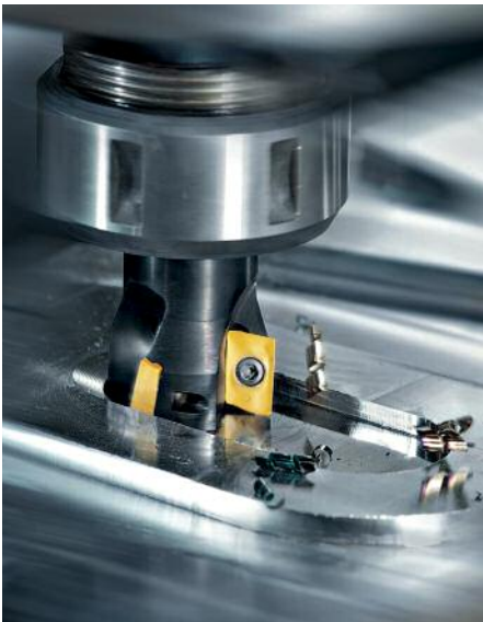
使用硬质合金刀具侧铣。© Seco Tools
