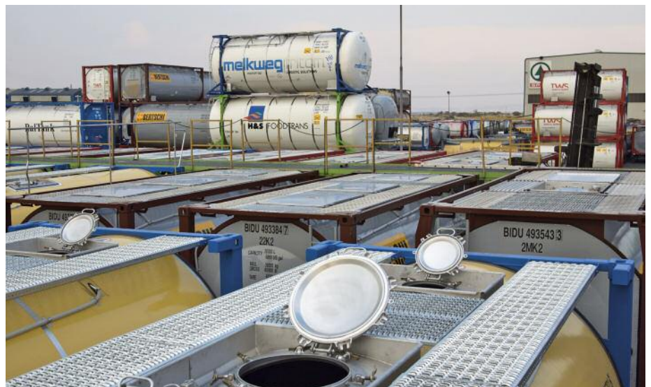
Intermodel罐式集装箱通常由316型不锈钢制成。它们被冷轧成圆柱形。© IMO A
