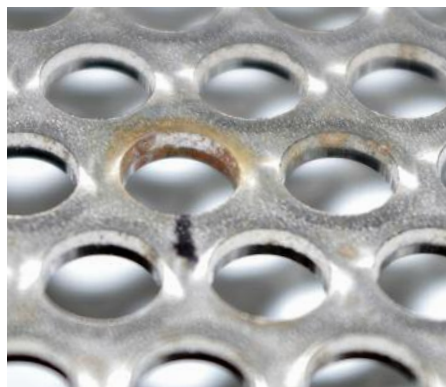
用穿孔模具冲孔会产生可见的磨光面和断裂面。钝工具造成的断裂面更粗糙，抛光面和断裂面的交界处出现金属重叠，这些孔更容易受到腐蚀。© Catherine Houska
