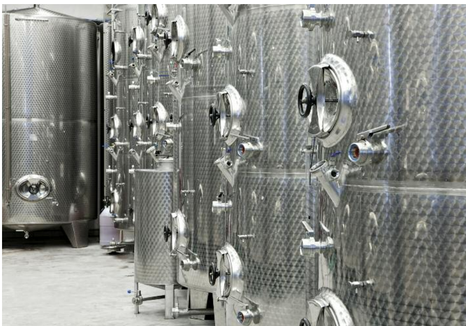
葡萄酒罐通常使用小圆形花纹抛光饰面，这种饰面具有卫生、易清洁，装饰性好，凹痕和划痕遮挡性强的特点。饰面要求是设计的重要组成部分。© iStock.com/Josef Mohyla
