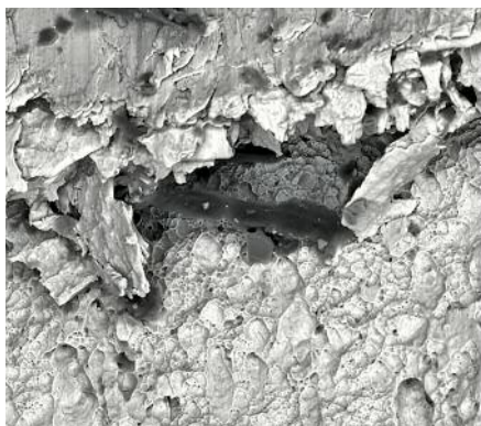
用穿孔模具冲孔会产生可见的磨光面和断裂面。钝工具造成的断裂面更粗糙，抛光面和断裂面的交界处出现金属重叠，这些孔更容易受到腐蚀。© Catherine Houska
