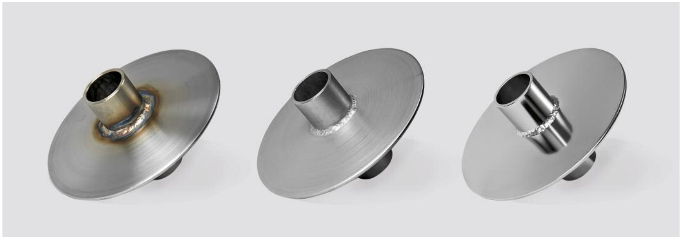
焊接部件制作后清理：左：焊后，中：酸洗，右：电抛光。© Calamo AB
