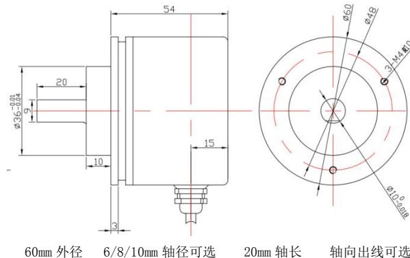
夹紧法兰 ( 电缆输出或插头输出可选 )
