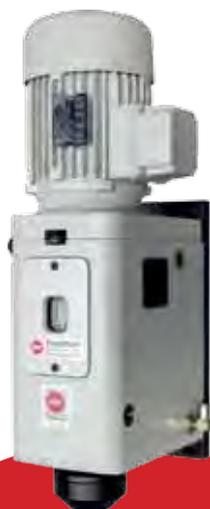
Unité pneumatique de rivetage à procédé radial par points
