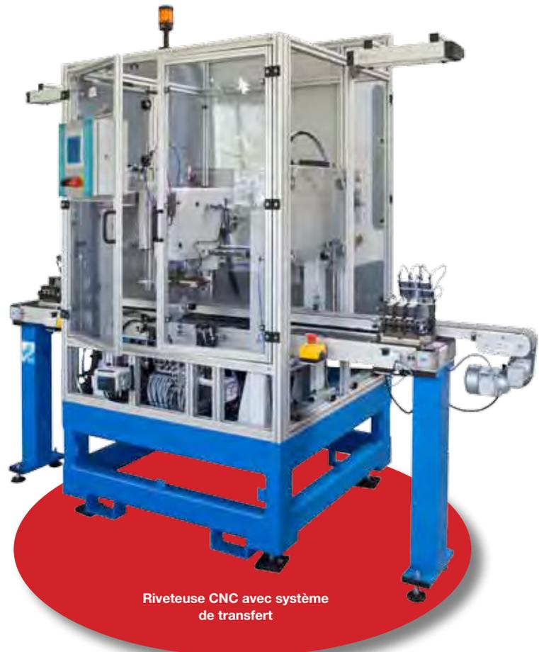
Riveteuse CNC avec système de transfert
