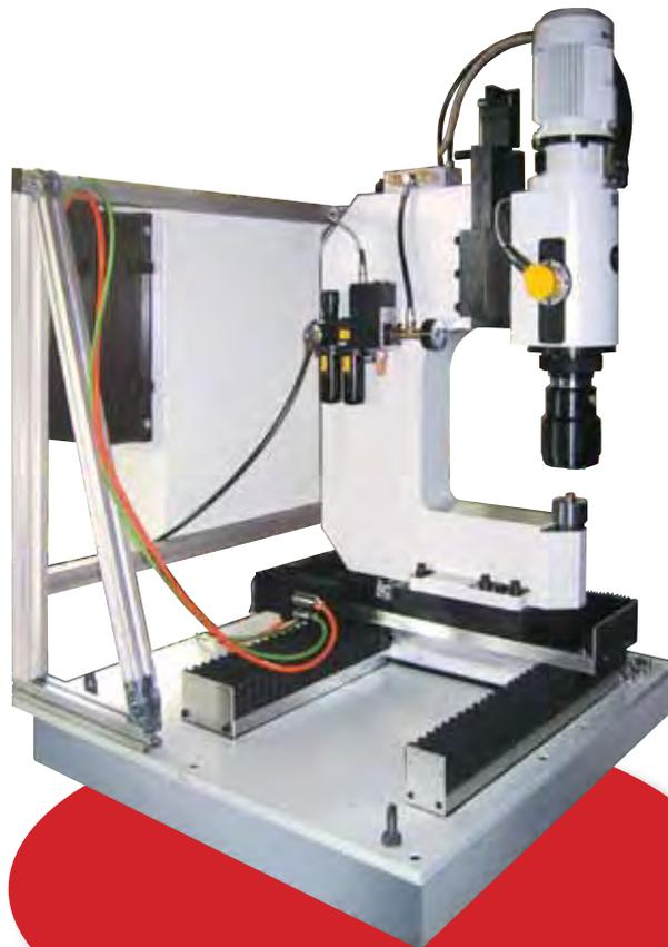
Riveteuse CNC utilisée comme module
