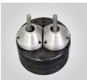
Têtes multibroche pour rivetage radial par points
