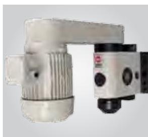
Двигатель сверху, фланец поворачиваемый пошагово на 30°
