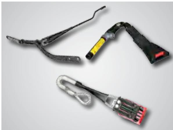
Кронштейн щетки стеклоочистителя – замок ремня безопасности – натяжитель ремня безопасности
