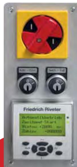
Стандартная система управления станком двумя руками
