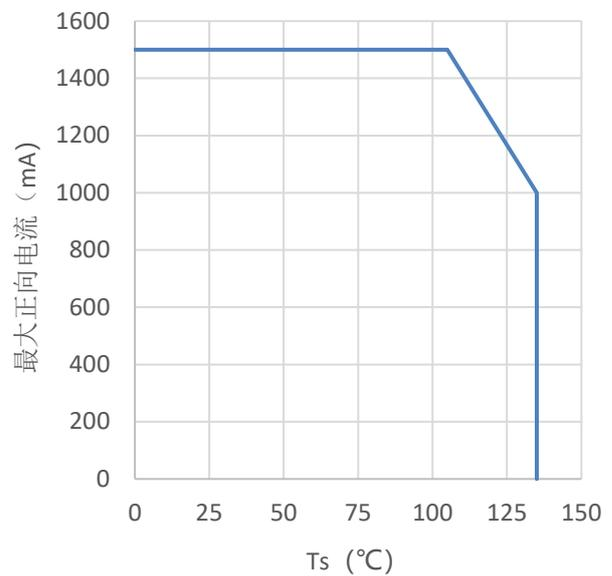
注：驱动1500mA时请确保LED焊点温度不超出105°C，否则请降低电流使用。
