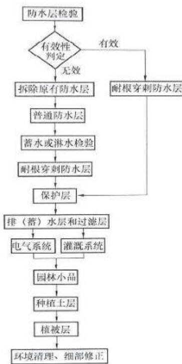
图 6.1.4 既有建筑屋面覆土种植施工工艺流程图
