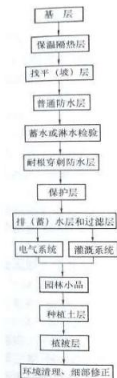
图 6.1.3 新建建筑屋面覆土种植施工工艺流程图
