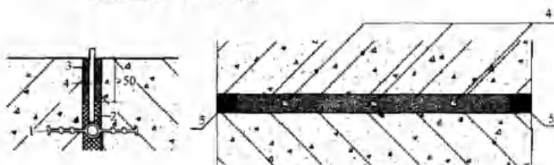
图 4.2.4-3 变形缝埋管(嘴)注浆止水
