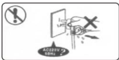
使用前需先检查插座的电压是否为交流电220V/50Hz；拔出插头前先关闭机械电源开关，勿用湿手拔电源插头
