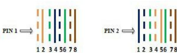
注意：PIN1 中的绿色条线应该跨越蓝色对线，如将绿白线与绿线相邻放在一起，会造成串扰，使传输效率降低。PIN1 的线序为橙白、橙、绿白、蓝、蓝白、绿、棕白、棕。
