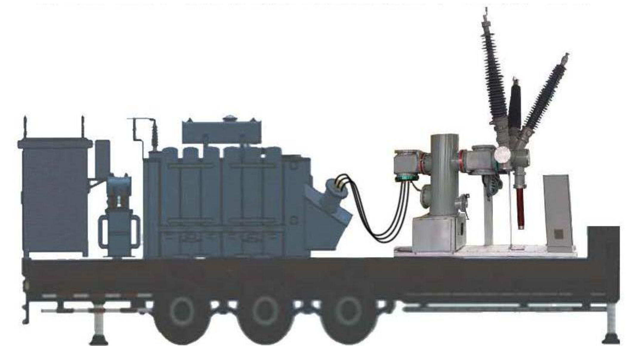
Trạm biến áp lưu động sử dụng GIS đơn giản hóa
