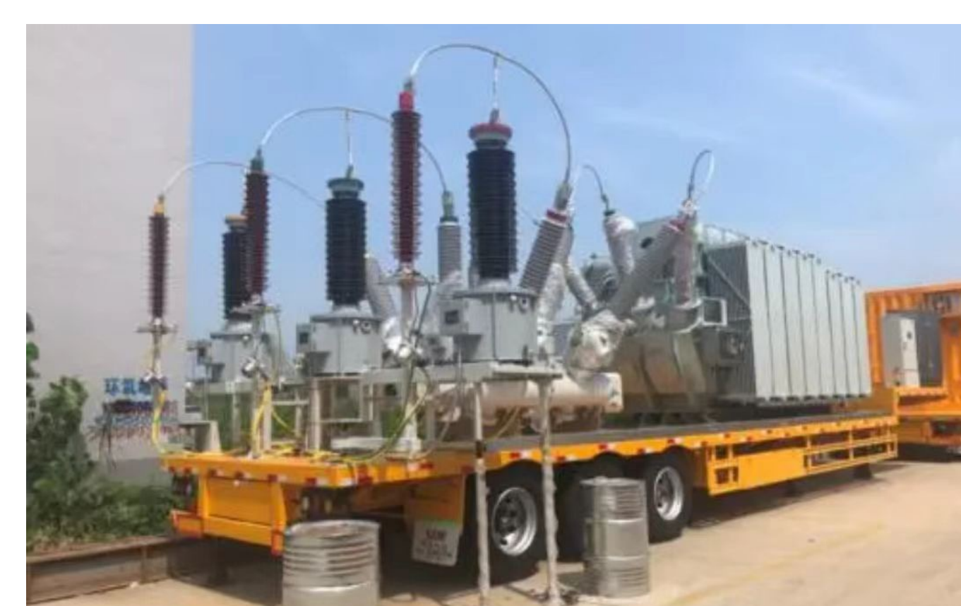
สถานีย่อยเคลื่อนที่ 110kV
