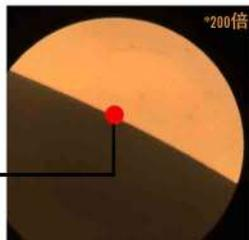
\*200倍显微镜下观察刀刃面也很光滑，刀刃上没有切口和毛刺。
