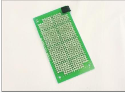
2. 从PCB止动器上取下纸张，将橡胶粘在PCB的孔上。
