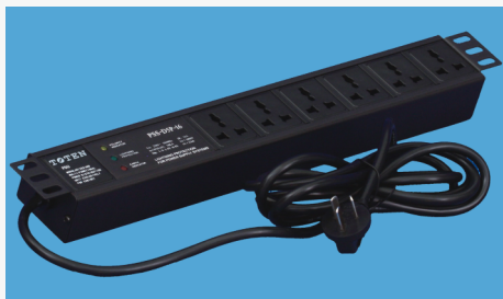
6位国标PDU, 10A输入输出，带防雷模块，无 开关，线长3M，19" 正方向安装, 带TOTEN丝印 (PD.0601.9100)
