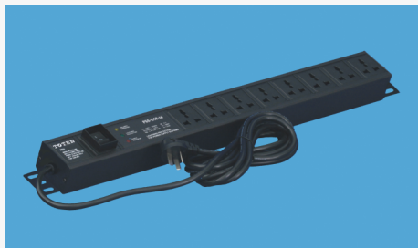
8位国标PDU, 10A输入输出，带防雷模块及总开 关，线长3M，反方向安装, 带TOTEN丝印 (PD.0801.9100)
