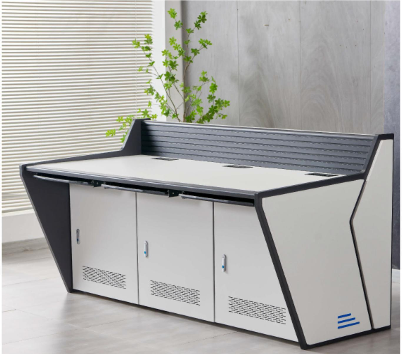
速拼式豪华操作台，主体框架采用无螺丝卡扣式组装方式，可实现快速组装随意组合，台体底座装有高度可调节水平地脚支撑，每个工位配备一组键盘抽屉和一组19寸机架和一块托盘。操作台面和侧板选用E1级环保实木颗粒板，台面黑白套色喷漆。铝型材屏风高度200mm，可以安装各型号显示器支架。金属框架选用优质冷轧钢板，整体框架厚1.5mm,前后门厚1.0mm,木质台面厚度25mm，铝型材厚度2.0mm，操作台所有金属构件表面喷涂柔性磨砂哑光漆。
