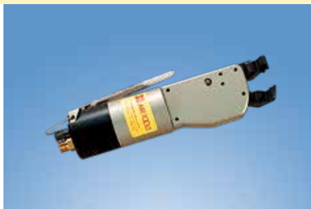
型號：BN-19（氣動式） 總長：165mm 重量：500g 氣體壓力：5 ~ 6kg/cm 2 氣體消耗：160cm 3 /stroke
