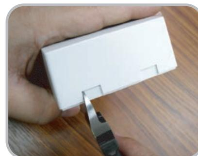
3.使用切割机切割电缆出口的侧
