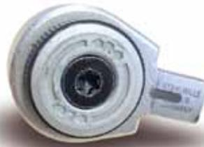
■ 集成RFI-TAG功能的棘轮头能自动选择对应的PSet程序
