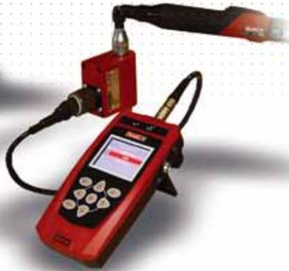
DELTA 6D可从DRT传感器读取角度，是测试高级电动扳手T&A策略的理想装置。DELTA 6D采用工具和Pset，以及路由管理定义，可做数据统计（ISO、CNOMO，或NF标准），曲线以及与CVI 控制器或条码枪之间的串口通信。与DeltaQC授权版软件配合使用时，提供SPC分析、追溯重叠及离线编程功能。
