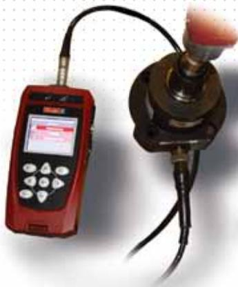
理想的扭矩测量装置。与DRT或DST传感器配合使用，可进行扭矩扳手和脉冲工具测试。Delta 1D无需任何编程，可随时测试选定的工具，显示实时最小、最大及平均数值。可提供完整的结果和XLS报表。
