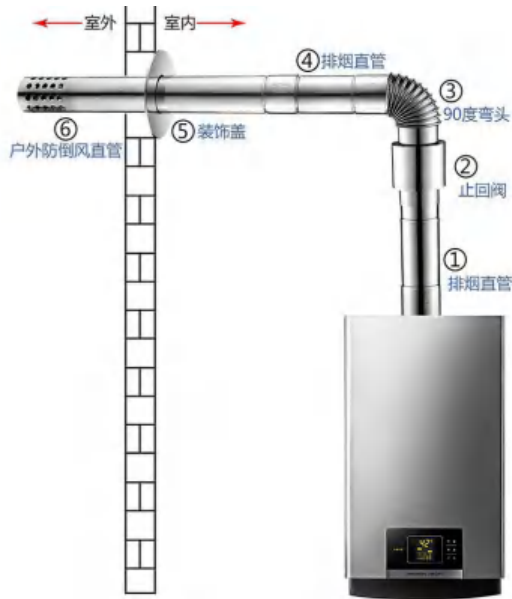
燃气热水器排烟管安装示意
