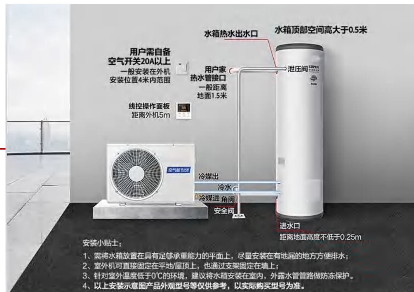
空气源热泵热水系统安装示意图
