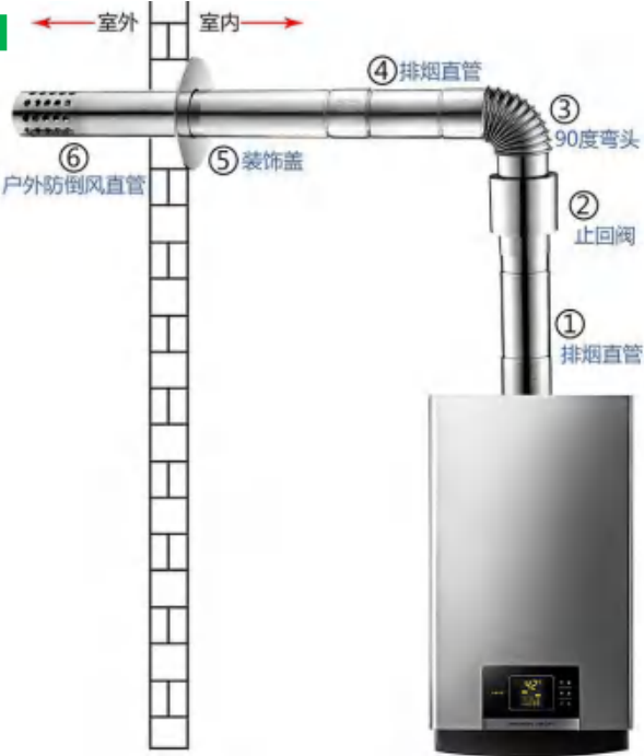
燃气热水器排烟管安装示意
