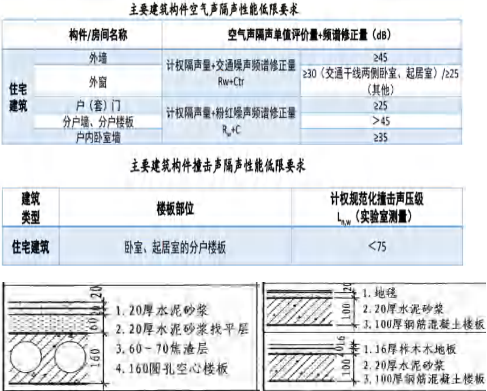
图B5-1 楼板构造做法
