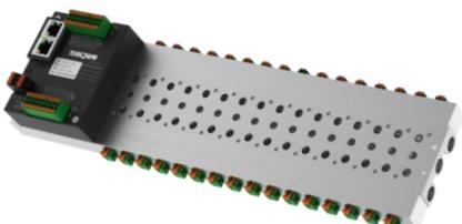
创新的模块化设计，支持单控或双控电磁阀，支持 32 个 DO 控制点，集成 32 个 DI 点，方便就近采集传感器信号，减少接线长度，降低成本；可支持 SMC、FESTO、CKD、AirTAC 等主流电磁阀型号；支持多种总线协议。底座采用全铝合金设计，可根据客户的电磁阀型号及位数进行底座定制。
