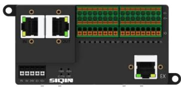
全新一代远程 I/O，螺丝固定式网线接口，适用于各种振动环境，可装于机械臂，可用于柜外分布式安装；采用 I/O、24V 和 GND 三线一组设计，满足现场传感器供电、信号采集和控制一体化，共用回路，无需并线，降低成本、维护更简单。32 点机型 长宽高为：105\*55\*37mm，占用空间更小，可灵活布置于狭小空间。
