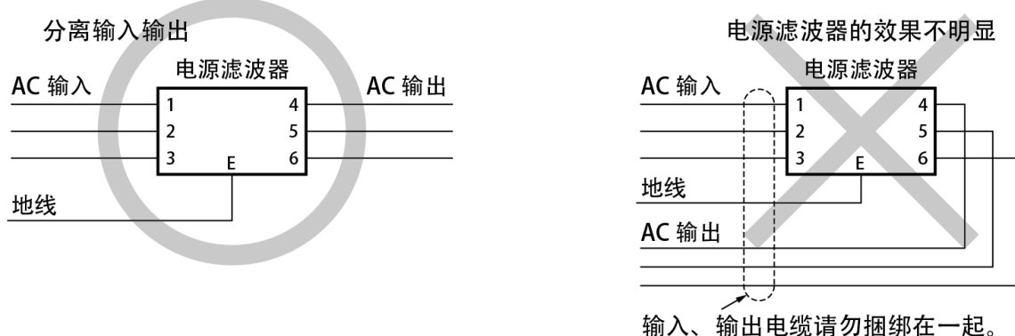
图 2.1-4 电源滤波器连接时请注意
