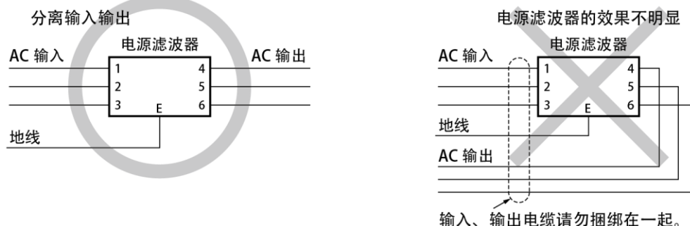
图 2.1-4 电源滤波器连接时请注意
