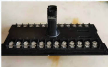
▲ 仪表接线采用高低压分离，确保安全和使用避免干扰
