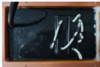
▲ 耐高压真空继电器分离式双控设计，环氧树脂浇注。
