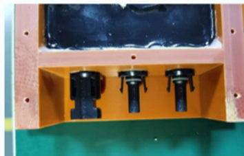
▲ 耦合器端子采用防水无接触端子
