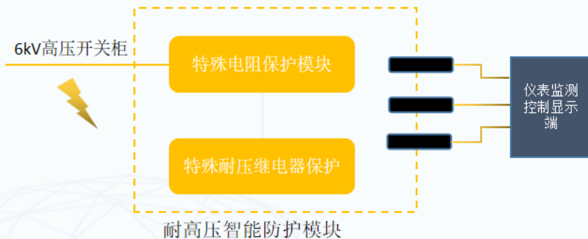
▲ 耐高压真空继电器分离式双控设计，环氧树脂浇注。
