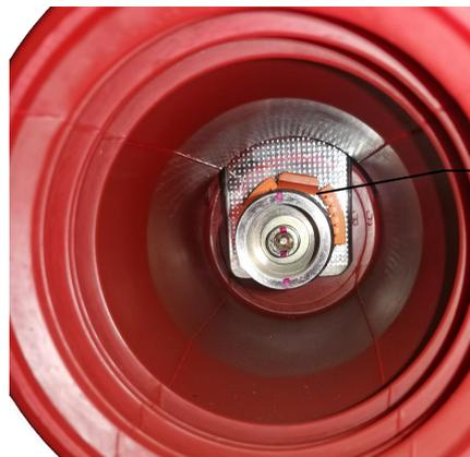
● 将合金带推至静触头底部
