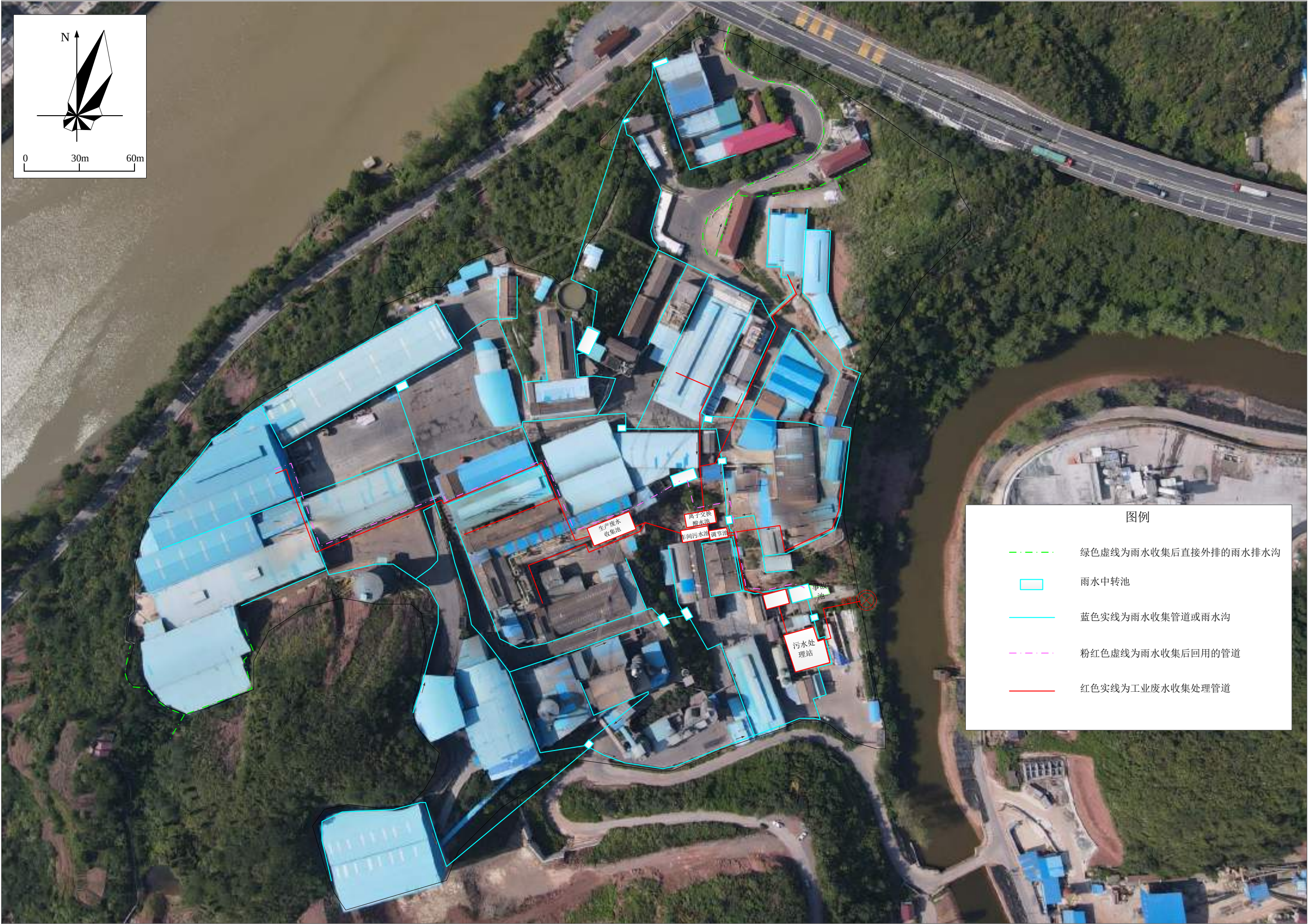
附图3、厂区雨污管网图
