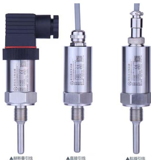
GE-WT...温度变送器产品采用数字传感器 DS18B20 作为温度测量部件，配以稳定可靠信号处理电路，将环境中的温度信号转换成与之相对应的标准信号，选用高质量集成式数字温度传感器，保证了变送器的长期稳定性、低延滞性及强抗化学污染能力，变送器可重复性。
