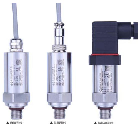
GE-DPT 系列管道压力变送器测量范围宽，能适用于大多数工业级使用环境；电压信号输出量程可在 0~5VDC、0~10VDC 间选择，也可采用 4~20mA 电流信号输出。将压力信号转换成与之相对应的标准信号，选用高质量集成式不锈钢压力感测元件，保证了变送器的长期稳定性、低延滞性及强抗化学污染能力，变送器可重复性。
