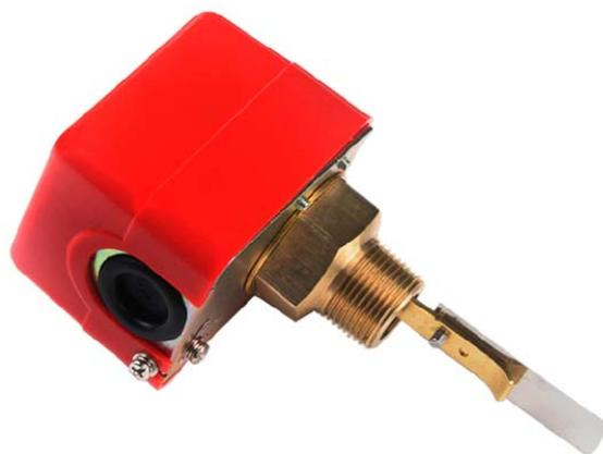
GE-WFS 水流开关采用靶式传感器，可用水冷却系统或其他流体回路的水流状态监测，水流压力设定值可通过螺母微调。
