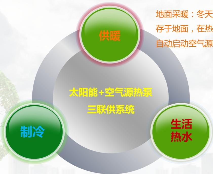
地面采暖：冬天利用太阳能集热并直接储存于地面，在热量达不到设定温度值时，自动启动空气源热泵做热补充。
