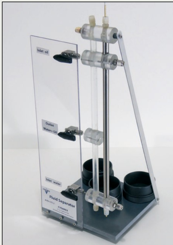
分离器采用电容式液位精确测量，连续记录。
